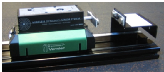
Zostava experimentu pre impulz - hybnosť pomocou adaptéra dynamickej dráhy
