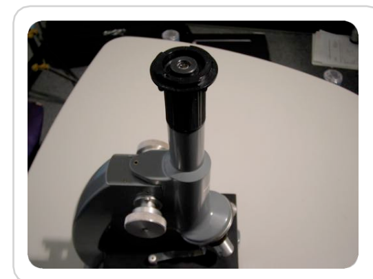
Ak sa pod okulárom mikroskopu nenachádza závit, budete potrebovať adaptér bajonetu C a adaptér tubusu.
