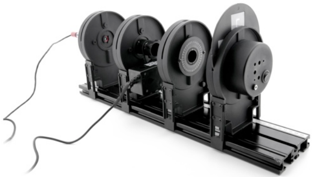
Modifikovaná zostava so senzorom svetla a nastaviteľným analyzátorom pre senzor otáčavého pohybu
